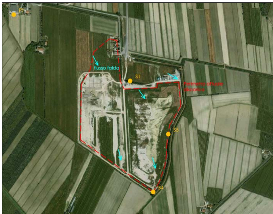
Figura 8 – Piezometri relativi a monitoraggio su falda superficiale da parte di ARPAV (elaborazione TERRA Srl)
