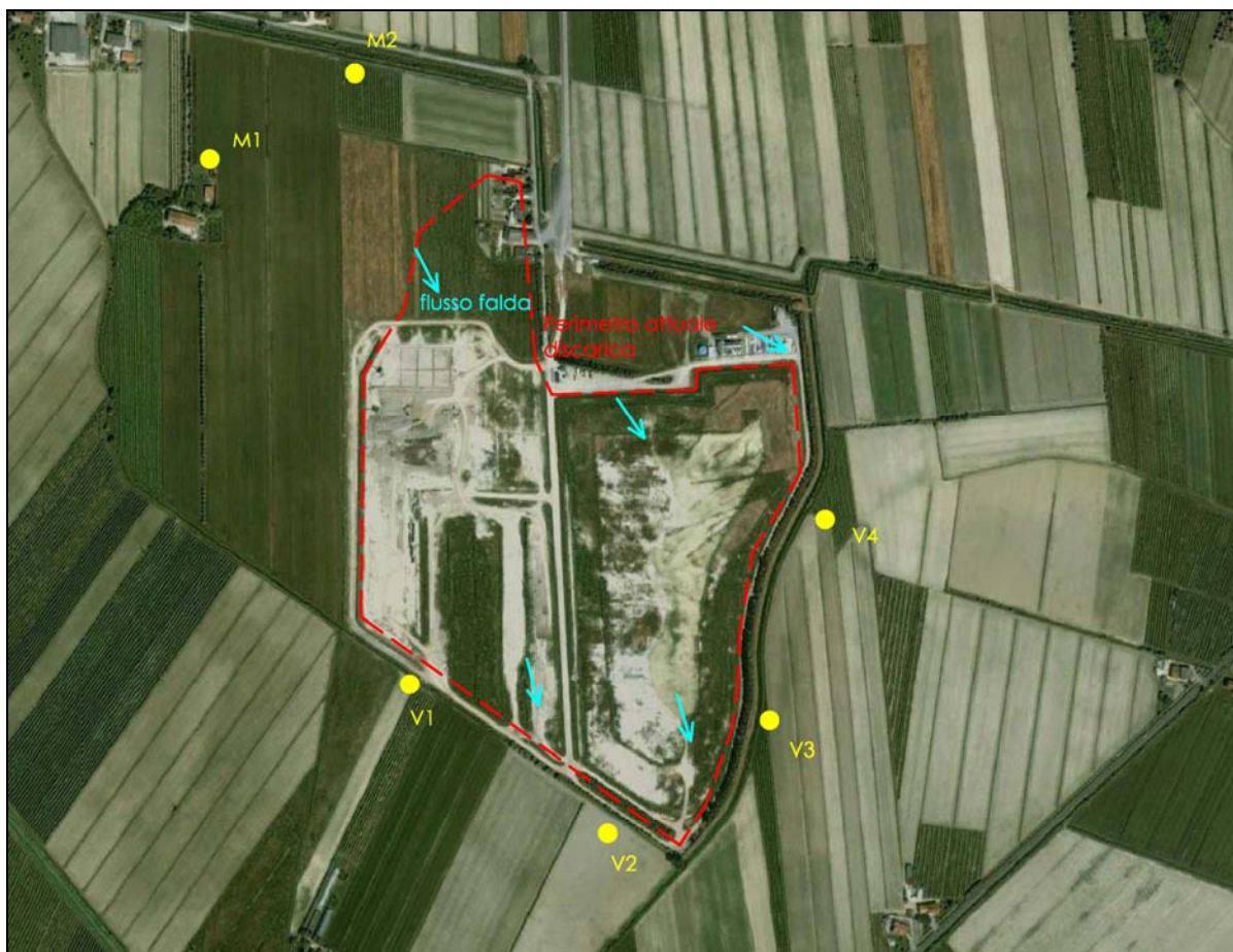
Figura 14 – Proposta punti di campionamento acque sotterranee falda "superficiale" (profondità 6 m da p.c.)
