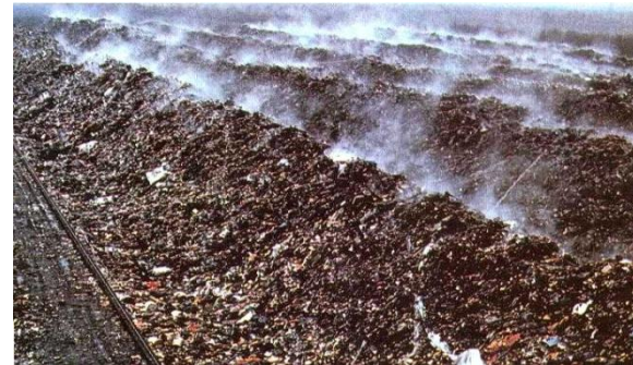
Compost in fase di trattamento prima della vagliatura
