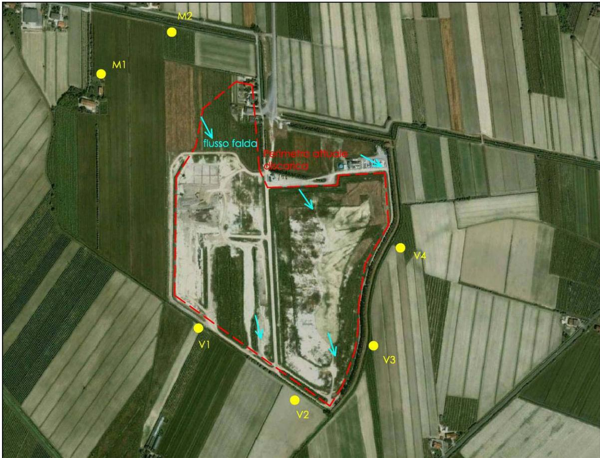
Figura 2.7 – Proposta punti di campionamento acque sotterranee falda "superficiale" (profondità 6 m da p.c.)
