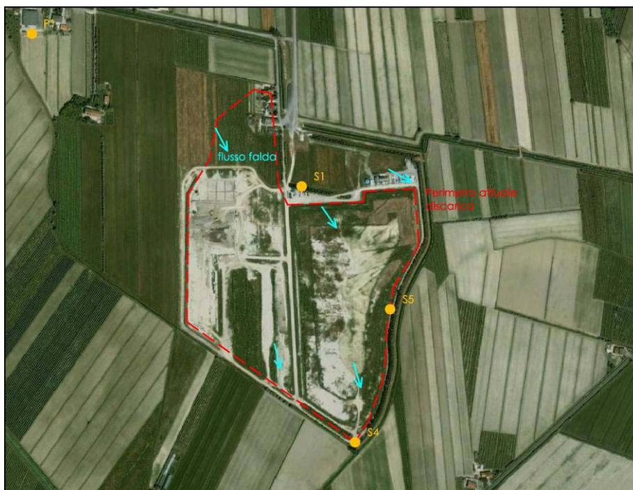
**Figura 2.1** – Piezometri relativi al monitoraggio ARPAV sulla falda superficiale (Relazione TERRA SRL 2011).
