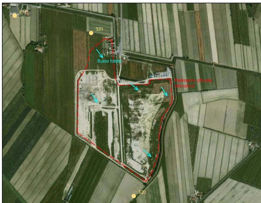
Figura 2.2 - Piezometri relativi al monitoraggio ARPAV sulla falda profonda (Relazione TERRA SRL 2011)
