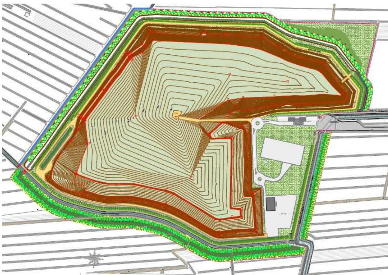
Sistemazione Finale della Discarica
