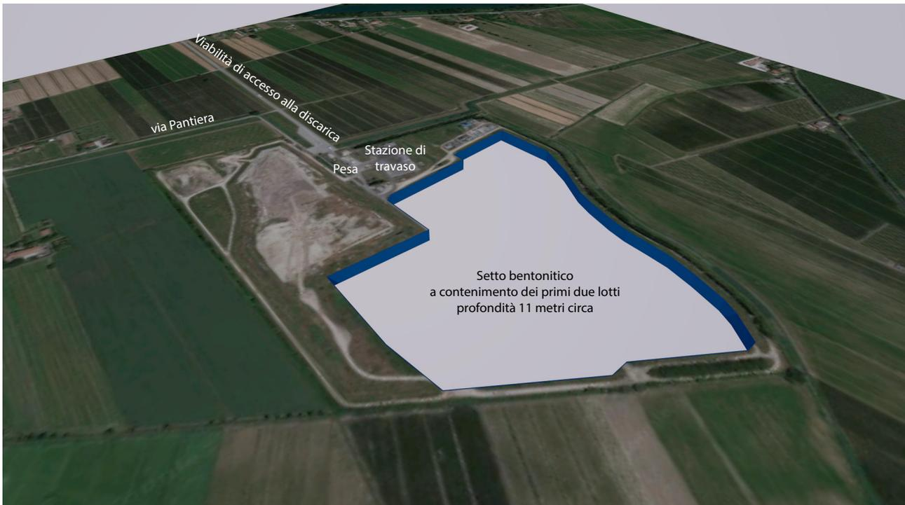
Figura 4: Setto bentonitico perimetrale di contenimento
