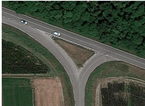
Figura 5: Configurazione viabilistica di immissione che consente solamente la svolta a destra in uscita dall'impianto
