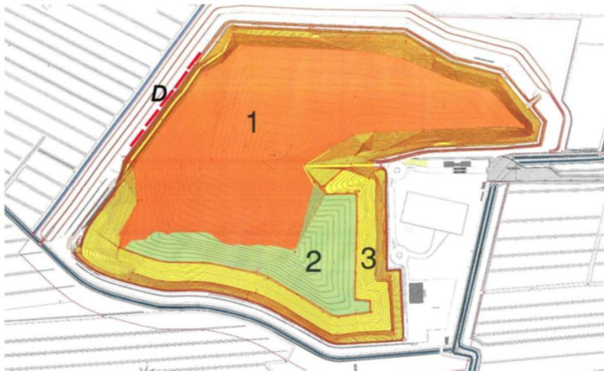
Figura 16: Particolare del capping di copertura come indicato a pagina 49 della Relazione Tecnica Generale
