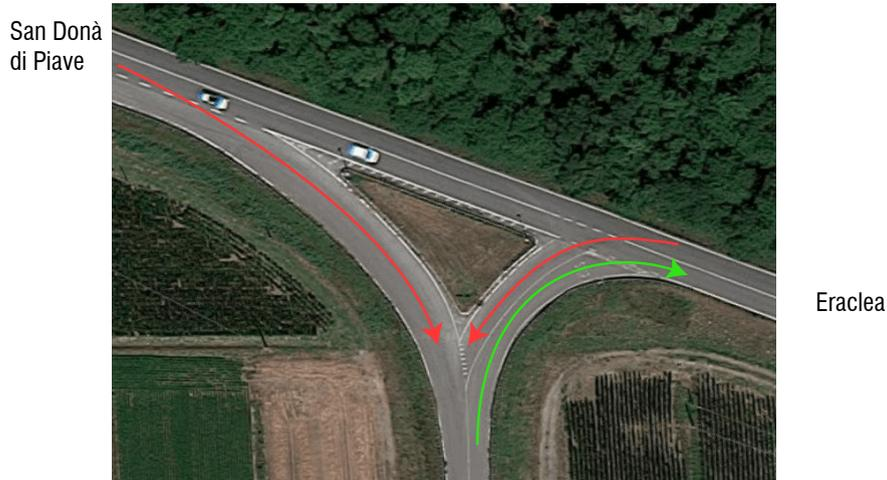
Figura 12: Configurazione viabilistica che consente, in uscita, solamente la svolta a destra
